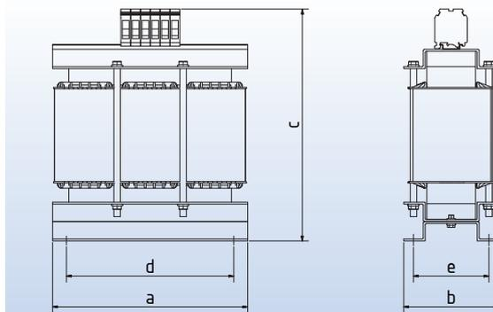
**Dreiphasen-Motordrosseln für Betrieb an Frequenzumrichtern nach VDE 0570 Teil 2-20, EN 61558-2-20**
