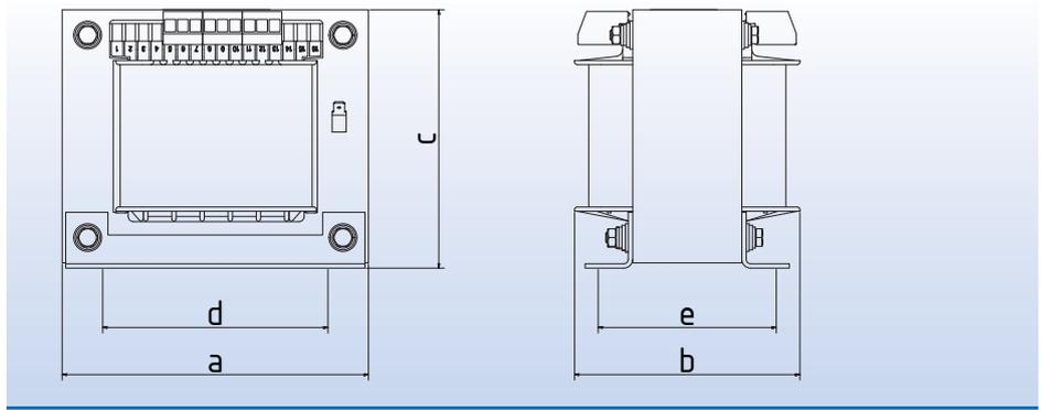
**Einphasen-Steuertransformatoren nach VDE 0570 Teil 2-2, EN 61558-2-2**
