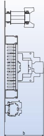
**Vormagnetisierungseinheit zur Vermeidung von Einschaltstoßströmen**
